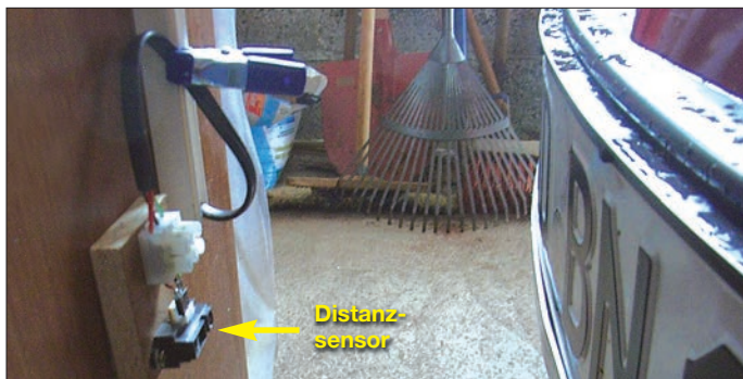
Bild 2: Anzeige Halt beim Erreichen eines zuvor eingestellten Mindestabstands
