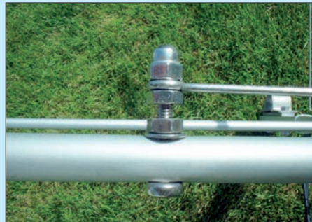
Bild 14: Anschluss der Phasenleitung am Antennenelement mit einer M4 x 25-mm-Edelstahlschraube und einer M4-Hutmutter
