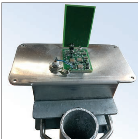
Die Aktivantenne lässt sich in dem Außengehäuse der Firma Otto Schubert wetterfest unterbringen und an einem Antennenrohr stabil befestigen. Foto: DL3HRT
