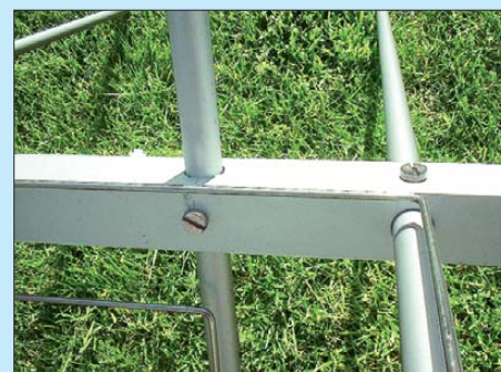
Bild 5: Befestigung der Antennenelemente mit M4-Schrauben
