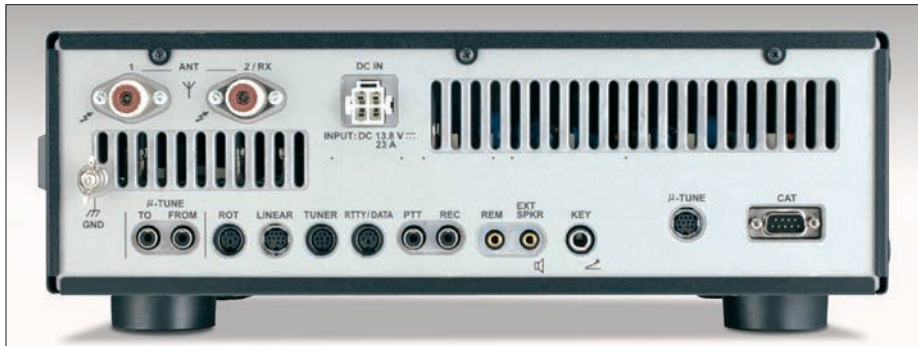
Bild 2: Rückansicht des FTdx1200. Von den beiden Antenneneingängen lässt sich einer für den Betrieb einer separaten Empfangsantenne schalten. Zum Anschluss einer Morsetaste liegen je eine Buchse auf der Front- und auf der Rückseite des Transceivers. Beide Eingänge sind getrennt für den Betrieb verschiedener Morsetastentypen programmierbar. Die PC-Fernsteuerung läuft über RS232.
