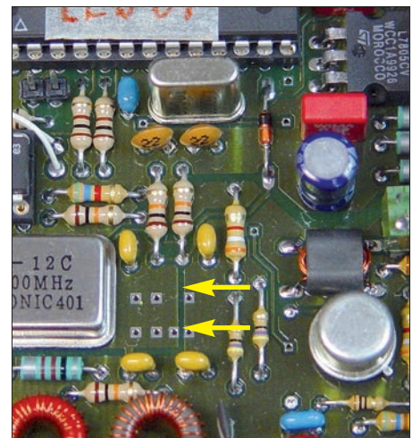
Bild 5: Getrennte Masseflächen des digitalen und analogen Teils eines DDS-VFO; für Gleichströme sind die Massen mit einer Drossel verbunden.
