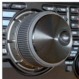
Bild 3: Der spielfrei laufende große VFO-Knopf liegt optimal, sobald man den FTdx1200 mithilfe der ausziehbaren vorderen Standfüße leicht schräg stellt.
