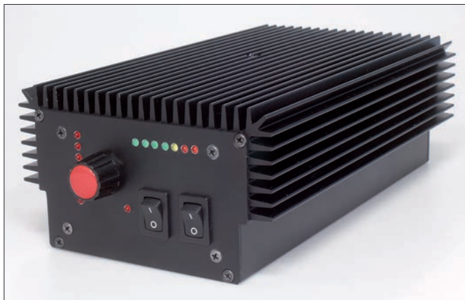
Bild 1: Prototyp der 50-W-Endstufe im Kühlrippengehäuse; die Frontplatte ist noch unbeschriftet. Links befindet sich der Drehschalter für die Tiefpassfilter, die beiden Wippschalter rechts dienen als Ein- sowie als Umschalter für die Eingangsleistung.
