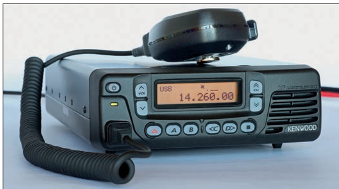
Die Frontplatte des Kenwood TK-90 OE lässt sich abnehmen und separat montieren.
