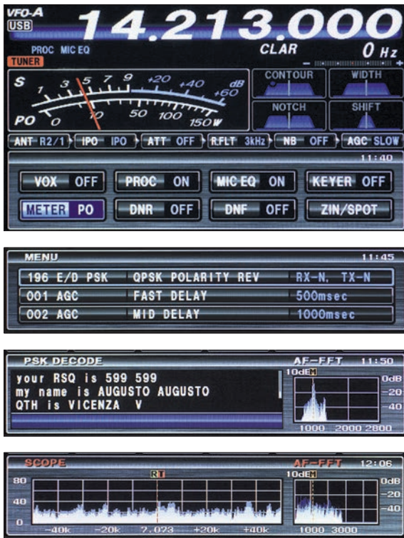
Bild 6: Das TFT-Display zeigt ständig zentrale Betriebsparameter. Ebenso hat man im Blick, welche Zusatzfunktionen (Notch, VOX usw.) aktiv sind.
