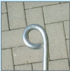
Bild 10: Ansicht nach dem Ausrichten des Befestigungsauges
